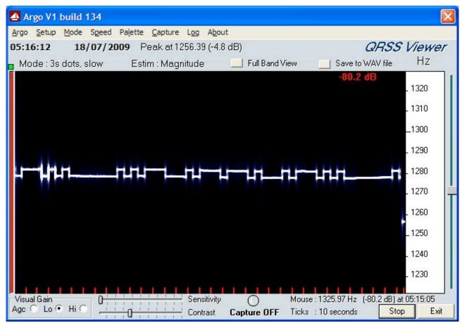
Il condensatore a treccia C3 deve essere regolato per avere una variazione di frequenza di circa 4-5 Hz. Non sprecare spettro utilizzando uno shift maggiore. 4-5 Hz e' sufficiente e preferibile. Stringi di piu' C3 per avere un aumento dello shift o svolgilo per avere una diminuzione dello shift.
