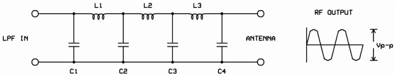
La conception utilise quatre condensateurs et trois inductances enroulées sur trois tores, et il a une impédance d'entrée et de sortie de 50 ohms. Le petit PCB a une fiche à 4 broches sur son entrée et sa sortie. Il est conçu pour tenir sur le kit d'émetteur "Ultimate2" multi-mode QRSS / WSPR, mais peut bien sûr être utilisé comme un filtre passe-bas pour d'autres conceptions d'un émetteur QRP. Il intègre également le kit LPF relais commuté.
