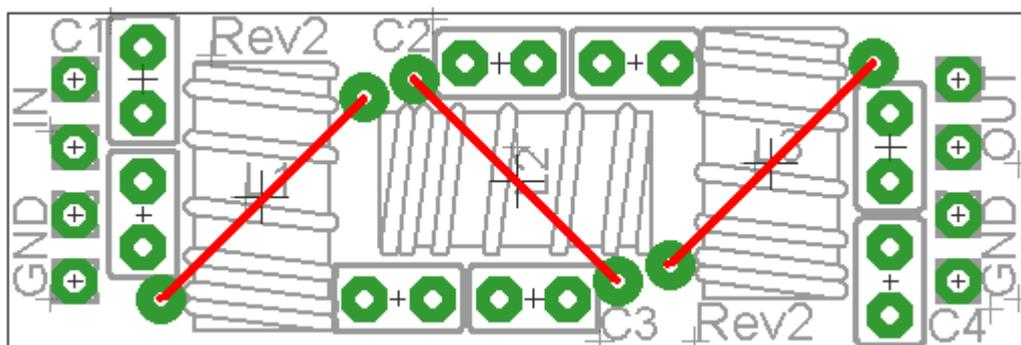
Note pour le kit 17m : les condensateurs C1 et C4 condensateurs doivent être 110pF selon la page Web du G-QRP, mais je ne pouvais pas trouver un condensateur de 110pF, donc un 100pF est utilisé et devrait être un substitut raisonnable.
