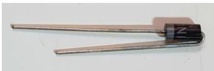
PCBの一つを底部 PCB として決めます。印刷されたシルクスクリーンを上にして部品を取り付けます。(右図) ダイオード D1 を上図のように曲げ、PCB 上に縦に立つように取り付けます。D1 と C1 を半田付けします。
