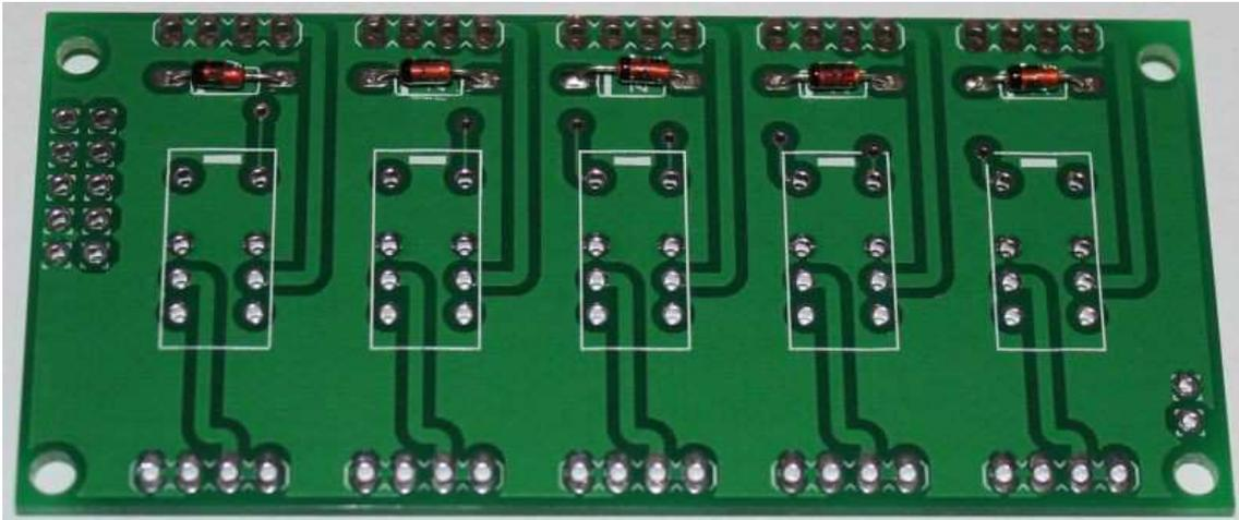
2) 5個のリレー付近にあるジャンパー線を配線します。このジャンパーの配線で共通アンテナ出力に接続するか個別アンテナ出力に接続するのを選択できます。ジャンパー線にはダイオードを実装した後に残ったダイオードの足の切れ端を使ってください。ここでジャンパーを配線するほうが、リレーや4極ソケットを実装したあとに配線するよりも簡単です。また、ジャンパー線は基板に隣接して配線せず、5mm程の高さでループ状に配線してください。その方が後で配線のとりはずしが楽です。ジャンパーの接続でどのような機能を選択できるか後に述べます。
