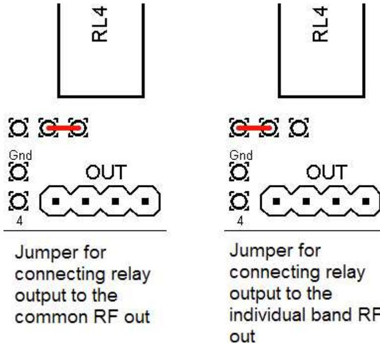
全てのリレー出力を共通アンテナに接続する場合は5回路分のジャンパ用の中心のスルーホールと右側のスルーホールを接続します。上図の左側(common RF out)の図の通りです。
