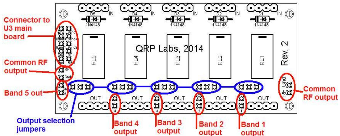
共通アンテナ出力はプリント配線板の左端と右端に配置しました。共通アンテナ出力は
