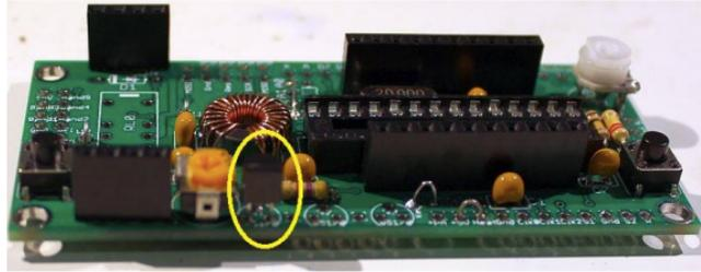
Les transistors sont situés au bord du circuit imprimé avec leur côté plat vers l'extérieur. Cela permet de fixer facilement un dissipateur thermique si vous le souhaitez (pour une tension et donc une puissance plus élevées).
