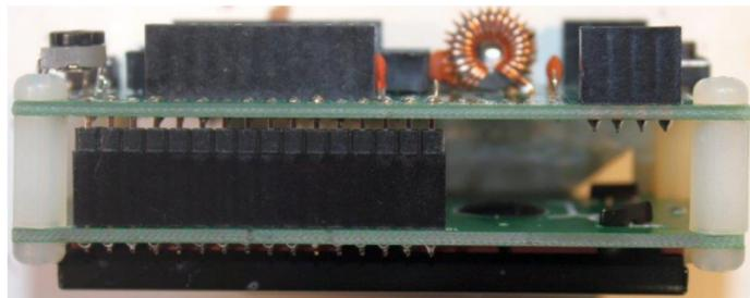
La fiche et la prise combinées 16 voies, une fois accouplées, ont une hauteur d'un peu moins de 12mm. Par conséquent, il est nécessaire de laisser un vide quelque part. Ma méthode suggérée est illustrée à droite ici. Accoupler étroitement la fiche et la prise. Laissez l'écart entre le connecteur mâle et le circuit imprimé. J'ai trouvé cette méthode fonctionne avec succès.
