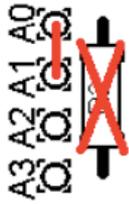
**b) Luminosité réduite :** vous pouvez trouver le rétro éclairage LED du module LCD trop brillant à votre goût ou, si vous souhaitez utiliser une alimentation par batterie, vous estimez peut-être qu'il consomme trop de courant. Dans ce cas, installez un cavalier entre A1 et A2 et utilisez une résistance appropriée à la position R2 :
