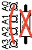
**d) Rétro éclairage commuté :** si vous ne souhaitez pas que le rétro éclairage LED du module LCD soit allumé en permanence, vous pouvez connecter les câbles à un commutateur marche/arrêt au lieu du cavalier de
