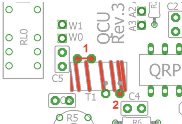
Vous devez connecter un fil de pont entre les deux trous à l'extrémité «1», comme indiqué. À l'extrémité «2», assurez-vous de placer le fil dans le trou de droite, à côté du condensateur C4. Laissez la gauche des deux trous vides!
