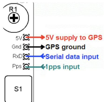
Le kit module récepteur GPS QLG1 de QRP Labs est alimenté en 5V et ne nécessite pas de résistances de rappel. Il convient pour une connexion directe au kit Ultimate3S.
