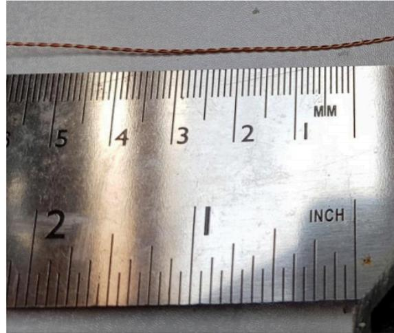
Maintenant, coupez les morceaux désordonnés d'un côté et la boucle de l'autre : c'est le fil qui servira à enrouler le noyau toroïdal FT37-43 en transformateur bifilaire.
