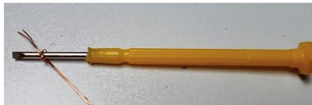
Lorsque vous avez déroulé et redressé le fil, pliez-le en deux (ne le coupez pas encore). Les deux moitiés doivent maintenant être étroitement liées pour former le fil bifilaire. Ma méthode consiste à faire un nœud autour d'un petit tournevis. Maintenant, fixez-le à quelque chose de solide. Vous pourriez utiliser un étau, si
