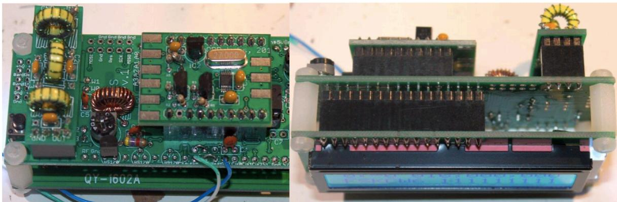
Assurez-vous que le module de synthétiseur Si5351A est inséré dans le bon sens, comme indiqué sur la photo. Le module de kit de filtre passe-bas doit être branché avec la légende «Out» alignée à côté du connecteur de sortie RF de la carte de circuit imprimé principale (voir photo).
