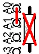
**a) Luminosité maximale:** Pour le fonctionnement de base connecter A0 à A1 en utilisant un cavalier (fait à partir d'une chute, par exemple). Le rétro-éclairage LED bleu du module LCD sera à pleine luminosité. Ceci est représenté par la ligne rouge (à gauche). Cela correspond à aucune résistance à la position R2.
