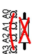
**c) Luminosité réglable par soft:** Le firmware U3 contient un paramètre de configuration du "Rétro-éclairage" qui peut être réglé de 0 (rétroéclairage OFF) à 9 (luminosité maximale). Ce résultat est obtenu en utilisant la modulation de largeur d'impulsion. Pour activer ce paramètre, vous devez connecter A0 à A3 en utilisant un cavalier (aucune résistance à la position R2).
