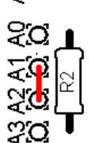
**b) Luminosité réduite:** Vous pouvez trouver le rétro-éclairage LED du module LCD trop brillant à votre goût, ou vous souhaitez opérer à partir d'une batterie, peut-être vous considérez qu'il consomme trop de courant. Dans ce cas, montez un cavalier entre A1 et A2, et utilisez une résistance d'une valeur appropriée à la position R2: par exemple, à partir de 100 ohms. 180 ohms est une bonne valeur. 220 ohms ou 270 ohms peuvent également convenir à votre goût.
