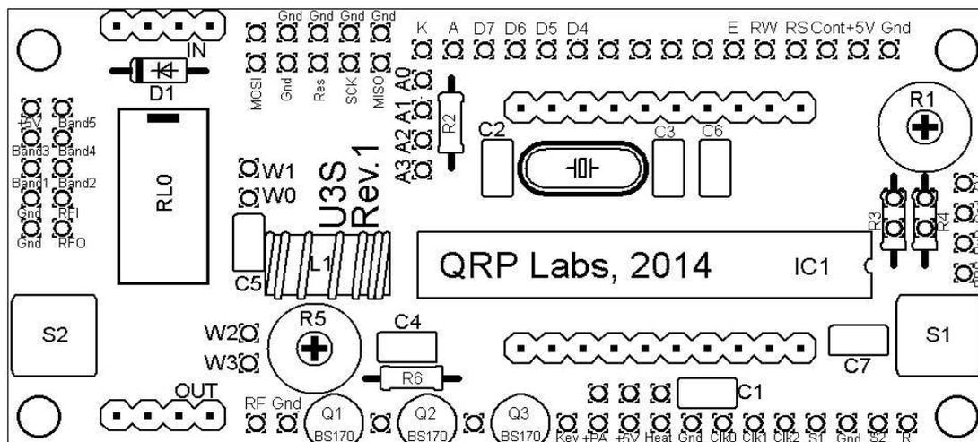
半導体の向きに特別注意してください。IC1のICソケットやICはシルク印刷のくぼみと方向が一致するように(訳者注 右側になるように) 特別注意してください。
