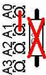
a) **最大輝度の設定:** 基本的な設定はA0とA1をジャンパー線で接続します。（ジャンパー線にはリード線の切りはし、たとえばコンデンサのカットしたリードを使います）LCDモジュールの青色LEDバックライトは最大期輝度になります。この配線を左図の赤線で示します。この設定ではR2の抵抗は不要です。
