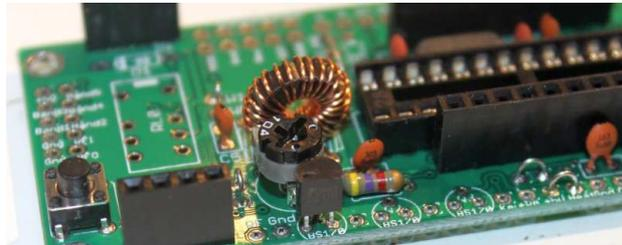
トランジスタの平らな面はプリント基板端面に配置されています。必要とあれば放熱板や放熱器を簡単に取り付けることができます。(高出力を得るために高い電圧をPAにかけた時に必要になるかもしれません。)
