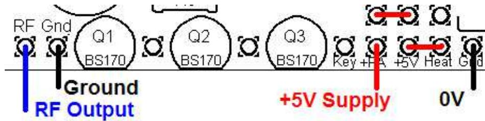
ールを使用した時だけ必要です。恒温槽用ヒータの接続として"Heat"と"5V"を接続します。
