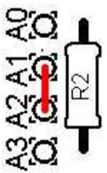
b) **輝度を下げる設定:** LCDのバックライトLEDが明るすぎると感じた時、あるいはU3Sをバッテリーで動作させ、消費電力が気になるとき、バックライトLEDの電流を減らすことができます。A1とA2の間にジャンパー配線を行い、R2の抵抗値を選択することでバックライトの明るさを制御できます。例えば100オームから徐々に抵抗値を増やしてください。180オームでいい具合の明るさになります。220オームあるいは270オームを選択しても良いでしょう。
