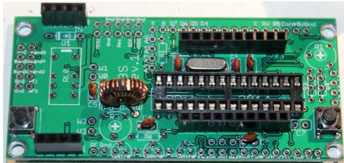
**6) LCDコントラスト調整用ポリウム R1の半田付け**
