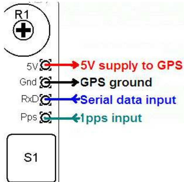
経度緯度情報が不要な場合 (WSPR以外のモード) あるいはWSPRを運用する場合でもグリッドロケータを手動で入力する場合シリアルデータ"serial data input"端子は開放としてください。"1 pps input"は周波数校正に利用します。"1pps signal input"にGPS以外の信号源、たとえば実験用発信器を接続することもできます。(訳者注 GPS並の安定な発信器が必要です) 周波数校正を利用するためには、送信しない校正用期間を設定する必要があります。詳しくは操作マニュアルのGPSインター
