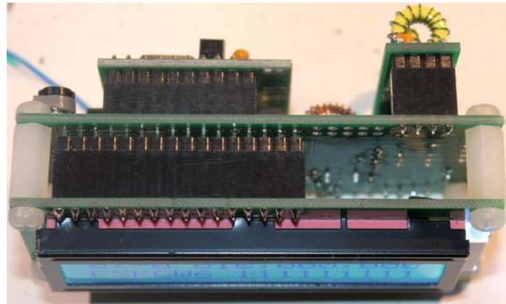
Si5351Aシンセサイザモジュールは上記の写真を通りの向きに取り付けて下さい。LPFモジュールは、“Out”がプリント基板のRF Outputコネクタ側になるようにして下さい。（写真参照）
