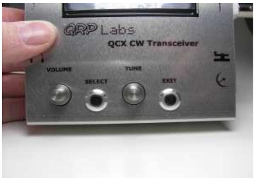
Abschließend wird nun Gehäuseunter- und Oberteil mit den vier verbliebenen M3x6 Schrauben verbunden. Scheibe und Sechskantmutter auf die Antennenbuchse, sowie die beiden Drehknöpfe montieren.
